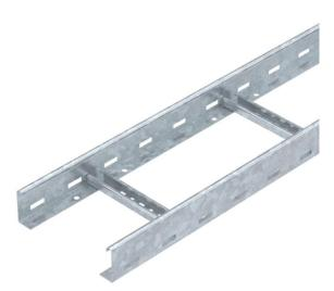
Échelle à câbles avec longeron perforé d'une hauteur de 60 mm, avec échelons VS rivetés (profilé en C) ouverts vers le haut.
