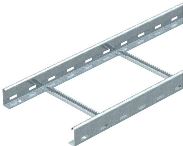
Échelle à câbles avec longeron perforé d'une hauteur latérale de 60 mm, avec échelons profilé en C, Modèle NS ouverts vers le haut
