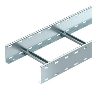
Échelle à câbles avec longeron latéral perforé d'une hauteur latérale de 110 mm, avec échelons rivetés à profilé en C ouvert vers le haut. L'échelle à câbles est livrée repliée.
