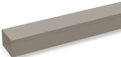
Goulotte de distribution LE pour la distribution encastrée des câbles à l'intérieur. Socle de goulotte avec fond perforé pour le montage. Difficilement inflammable et auto-extinguible après retrait d'une flamme ardente. Effectuer des changements de direction avec les pièces de forme et obturer les extrémités de goulotte à l'aide des embouts. Testé selon DIN EN 50085-1 et DIN EN 50085-2-1. Socle et couvercle dans le set.
