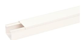
Goulotte de distribution LE pour la distribution encastrée des câbles à l'intérieur. Socle de goulotte avec fond perforé pour le montage. Difficilement inflammable et auto-extinguible après retrait d'une flamme ardente. Effectuer des changements de direction avec les pièces de forme et obturer les extrémités de goulotte à l'aide des embouts.
