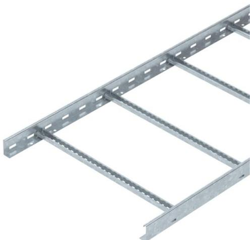
Échelle à câbles d'une hauteur latérale de 60 mm avec échelons soudés à profilé C30 ouvert vers le haut. Longeron latéral enroulé pour le renforcement et la protection des bords. La fixation sur console s'effectue avec des pièces de serrage de type LKS 40. La fente de l'échelon mesure 16,5 mm. La bride de fixation correspondante est de type 2056. Atténuation magnétique du blindage sans couvercle 10 dB, avec couvercle 15 dB.
