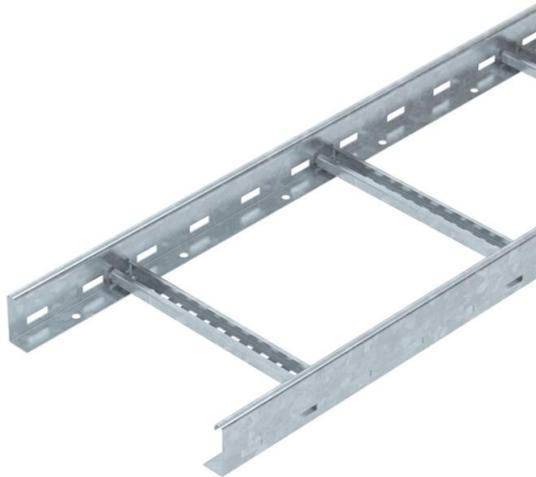
Échelle à câbles d'une hauteur latérale de 60 mm avec échelons soudés à profilé C30 ouvert vers le haut. Longeron latéral enroulé pour le renforcement et la protection des bords. La fixation sur console s'effectue avec des pièces de serrage de type LKS 40. La fente de l'échelon mesure 16,5 mm. La bride de fixation correspondante est de type 2056. Atténuation magnétique du blindage sans couvercle 10 dB, avec couvercle 15 dB.
