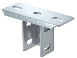
Plaque de tête pour montage sur montants US 5. En association avec le montant US 5, toutes les longueurs de pendards peuvent être fabriquées sur place. Convient également pour la fixation d'échelles verticales de type SLM 50. La plaque de tête peut être montée sur des longueurs fixes de type US 5. L'entretoise DSK 45 est utilisée lors du montage de la plaque de tête.
