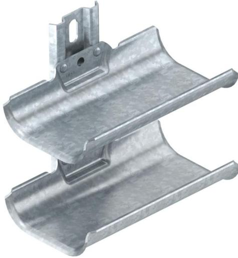
Les gouttières support de câbles sont destinées à une pose simple et rapide dans des zones n'offrant pas un espace suffisant pour montage de systèmes de support de câbles courants. Les gouttières support de câbles dispose d'une grande surface d'appui et de bords extérieurs arrondis pour protéger les câbles. Conformément à la norme DIN VDE 0298-300, ne pas dépasser un écart max. d'appui de 0,8 mm.
