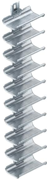
Les gouttières support de câbles sont destinées à une pose simple et rapide dans des zones n'offrant pas un espace suffisant pour montage de systèmes de support de câbles courants. Les gouttières support de câbles dispose d'une grande surface d'appui et de bords extérieurs arrondis pour protéger les câbles. Conformément à la norme DIN VDE 0298-300, ne pas dépasser un écart max. d'appui de 0,8 mm.
