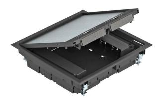
Boîtier de sol GES9 avec une hauteur de montage fixe de 55 mm. Avec deux boîtiers de montage pour le montage vertical d'appareillages Modul 45 et quatre décharges de traction. Pour le montage des appareillages Modul 45, deux cadres de montage sont nécessaires.
