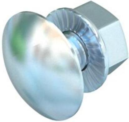
Boulon TRCC à collet carré galvanisé à chaud, avec écrou galvanisé par électrolyse à rondelle sertie.
