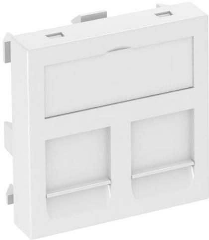
Support informatique avec sortie droite et poussoir d'obturation pour le logement de deux modules de raccordement informatiques avec prise RJ45 (femelle). La fixation à encliqueter convient pour le montage horizontal et vertical dans l'environnement du système. Le type RM présente un logement pour module spécial et est conçu pour la fixation indirecte des noyaux informatiques dans l'ouverture de montage.
