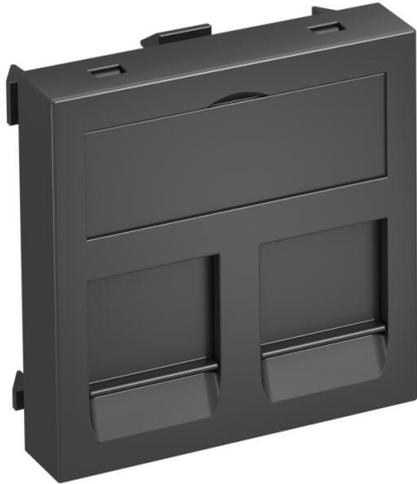
Support informatique avec sortie droite et poussoir d'obturation pour le logement de deux modules de raccordement informatiques avec prise RJ45 (femelle). La fixation à encliqueter convient pour le montage horizontal et vertical dans l'environnement du système. Le type EP présente un logement pour module spécial et est conçu pour la fixation indirecte des noyaux informatiques dans l'ouverture de montage.
