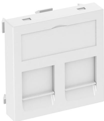
Support informatique avec sortie droite et poussoir d'obturation pour le logement de deux modules de raccordement informatiques avec prise RJ45 (femelle). La fixation à encliqueter convient pour le montage horizontal et vertical dans l'environnement du système. Le type A présente une ouverture de montage de 20,10 X 14,80 mm et est conçu pour la fixation directe des noyaux informatiques dans l'ouverture de montage.
