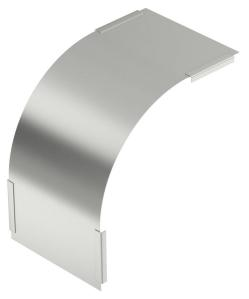
Couvercle pour coude vertical descendant d'une hauteur d'aile de 60. La fixation est assurée par le chevauchement du couvercle de chemin de câbles. Pour plus de solidité, le couvercle peut être fixé avec des clips de fixation pour couvercle.
