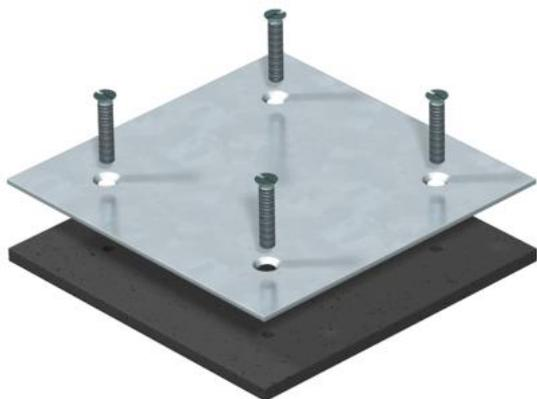
Obturbateur pour la fermeture ultérieure totale de l'ouverture de montage DAT. Avec plaque d'étanchéité en caoutchouc pour la protection contre l'humidité selon la norme DIN EN 50085-2-2, avec vis de fixation.
