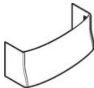
Couplage au sol pour le raccord entre la colonne de distribution et le sol.
