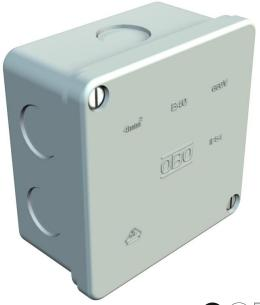
Indice de protection IP54, tension nominale 660 V, section nominale 4 -  $\,$  mm², 2 trous de fixation pour vis jusqu'à 4,5 mm de Ø à l'intérieur du boîtier, mais en dehors de la zone de serrage. Filetage M 6 et surface de contact sur le fond du boîtier. 2 vis de couvercle,
