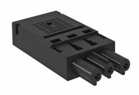
Partie femelle à 3 pôles, type GST18i avec raccord à ressort pour câble rigide de 1,5 à 2,5 mm², unifilaire ou soudé par ultrasons, câbles fins 1,5 mm² avec douilles d'extrémité, non montée avec décharge de traction, possibilité de confection sur place, 250 V, 16 A.
