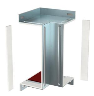
Hotte en partie moulée pour couvrir deux extrémités de conduit BSKM 1025 comme coin intérieur pour un montage direct au mur et au plafond. Inclut : joints collés pour étanchement des joints et joints séparés pour combinaison à une contre-plaque ainsi que des vis pour la liaison équipotentielle.
