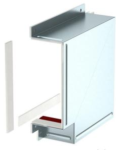
Hotte en partie moulée pour couvrir deux extrémités de conduit BSKM 1025 en angle plat pour un montage direct au mur et au plafond. Inclut : joints collés pour étanchement des joints et joints séparés pour combinaison à une contre-plaque ainsi que des vis pour la liaison équipotentielle.
