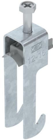
Bride de fixation avec pied W, plaque de pression en matière plastique en polypropylène. Pour montage vertical et horizontal d'1 câble individuel sur des cornières jusqu'à < 40 mm. Avec vis à 1 filet sur plaque de pression, tête de vis hexagonale universelle SW10, avec fente et empreinte cruciforme. Convient au montage en intérieur et en extérieur. L'utilisation d'une contre-plaque est recommandée.
