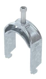
Bride de fixation avec pied N, plaque de pression en métal avec bords arrondis pour la protection des câbles. Pour montage vertical et horizontal d'1 câble individuel sur des rails profilés en C. Pour une ouverture de 11 – 12 mm. Avec vis à 1 filet sur plaque de pression, tête de vis hexagonale universelle SW10, avec fente et empreinte cruciforme. Convient au montage en intérieur et en extérieur. L'utilisation d'une contre-plaque est recommandée.
