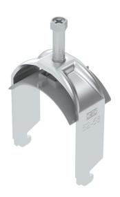
Bride de fixation avec pied N, plaque de pression en matière plastique en polypropylène. Pour montage vertical et horizontal d'1 câble individuel sur des rails profilés en C. Pour une ouverture de 11 – 12 mm. Avec vis à 1 filet sur plaque de pression, tête de vis hexagonale universelle SW10, avec fente et empreinte cruciforme. Convient au montage en intérieur et en extérieur. L'utilisation d'une contre-plaque est recommandée.
