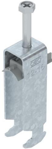
Bride de fixation avec pied H, plaque de pression en matière plastique en polypropylène. Pour montage vertical et horizontal de 3 câbles individuels sur des rails profilés en C. Pour une ouverture de 16 – 17 mm. Avec vis à 1 filet sur plaque de pression, tête de vis hexagonale universelle SW10, avec fente et empreinte cruciforme. Convient au montage en intérieur et en extérieur. Plusieurs câbles doivent être séparés par des plaques doubles. L'utilisation d'une contre-plaque est recommandée.
