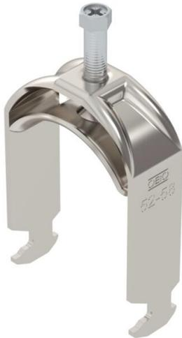
Bride de fixation avec pied H, plaque de pression en métal avec bords arrondis pour la protection des câbles. Pour montage vertical et horizontal d'1 câble individuel sur des rails profilés en C. Pour une ouverture de 16 – 17 mm. Avec vis à 1 filet sur plaque de pression, tête de vis hexagonale universelle SW10, avec fente et empreinte cruciforme. Convient au montage en intérieur et en extérieur. L'utilisation d'une contre-plaque est recommandée.
