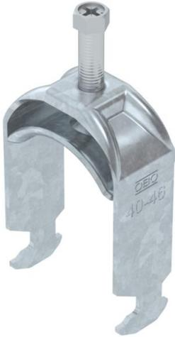
Bride de fixation avec pied H, plaque de pression en métal avec bords arrondis pour la protection des câbles. Pour montage vertical et horizontal d'1 câble individuel sur des rails profilés en C. Pour une ouverture de 16 – 17 mm. Avec vis à 1 filet sur plaque de pression, tête de vis hexagonale universelle SW10, avec fente et empreinte cruciforme. Convient au montage en intérieur et en extérieur. La contre-plaque doit être commandée séparément
