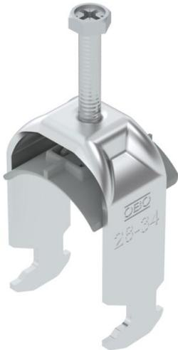
Bride de fixation avec pied H, plaque de pression en matière plastique en polypropylène. Pour montage vertical et horizontal d'1 câble individuel sur des rails profilés en C. Pour une ouverture de 16 – 17 mm. Avec vis à 1 filet sur plaque de pression, tête de vis hexagonale universelle SW10, avec fente et empreinte cruciforme. Convient au montage en intérieur et en extérieur. L'utilisation d'une contre-plaque est recommandée.
