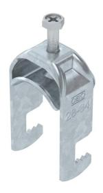
Bride de fixation avec pied F, plaque de pression en métal avec bords arrondis pour la protection des câbles. Pour montage vertical et horizontal d'1 câble individuel sur des fers plats. Avec vis à 1 filet sur plaque de pression, tête de vis hexagonale universelle SW10, avec fente et empreinte cruciforme. Convient au montage en intérieur et en extérieur. L'utilisation d'une contre-plaque est recommandée.
