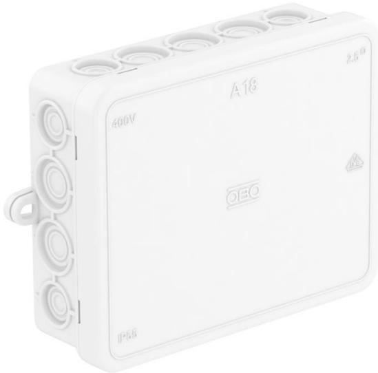
Indice de protection IP55, tension nominale 690 V, section nominale 2,5 mm<sup>2</sup>, 10 entrées pour diamètres de câble 5-14 mm
