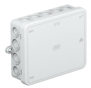
Indice de protection IP55, tension nominale 690 V, section nominale 2,5  $\div$  mm², 10 entrées pour diamètres de câble 5-14 mm
