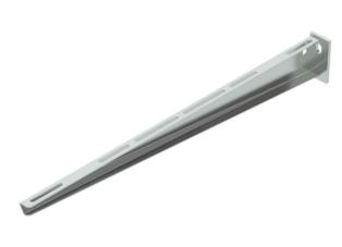
Console murale et de pendard légère avec plaque de tête soudée. Pour le montage de la console sur des pendards en U, il convient d'utiliser pour la fixation de la console de montant un boulon TRCC ou une vis à tête hexagonale, selon le profilé, jusqu'à une largeur de 400 mm. À partir d'une largeur de 500 mm, la console est fixée à travers les deux longerons du pendard en U à l'aide de vis à tête hexagonale. Il est bien sûr nécessaire d'utiliser l'entretoise adaptée, en fonction du profilé.
