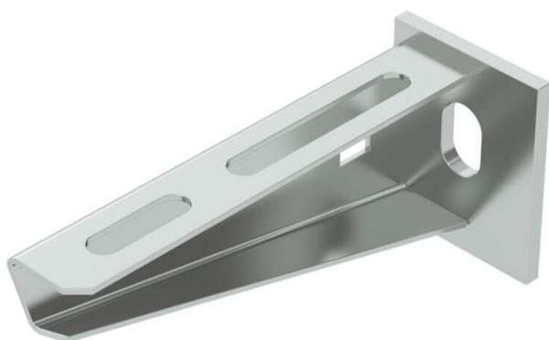
Console murale et de pendard légère avec plaque de tête soudée. Pour le montage de la console sur des pendards en U, il convient d'utiliser pour la fixation de la console de montant un boulon TRCC ou une vis à tête hexagonale, selon le profilé, jusqu'à une largeur de 400 mm. À partir d'une largeur de 500 mm, la console est fixée à travers les deux longerons du pendard en U à l'aide de vis à tête hexagonale. Il est bien sûr nécessaire d'utiliser l'entretoise adaptée, en fonction du profilé.
