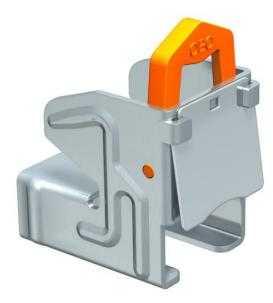
Attache pour poutrelle sans vis avec revêtement anticorrosion, avec ressort d'arrêt convenant aux rails profilés des types CML3518 et CMS3518. Pour la fixation rapide sur les profilés en acier lors du montage de chemins de câbles, brides de fixation BBS et suspensions de luminaires, etc. Un système complet se compose de 2 pinces de fixation et un élément de profilé en C d'une longueur au choix et de 2 embouts de protection.
