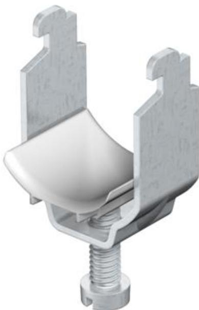
Convient pour tous les rails profilés avec une ouverture de 11 à 12 mm ; d'une hauteur intérieure d'au moins 6,5 mm et d'une largeur intérieure d'au moins 18,5 mm ;
