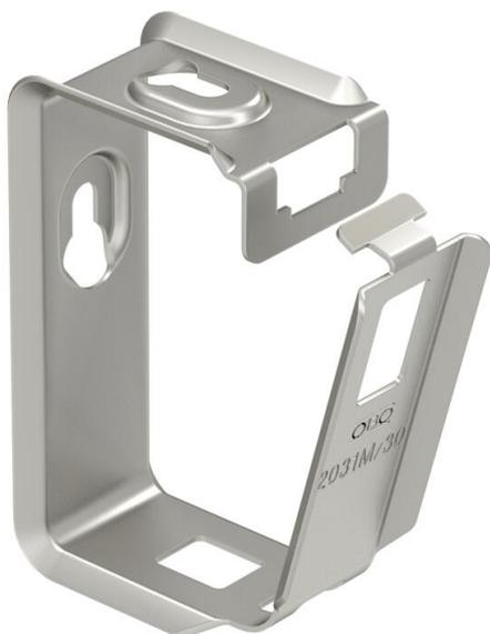
Passe-câbles métalliques pour une résistance mécanique élevée, même en cas d'incendie. Approprié pour un montage sécurisé au-dessus de plafonds coupe-feu. Autorisé également comme structure porteuse spécifique aux câbles pour le maintien en fonction selon la norme DIN 4102 partie 12. Pour montage au mur et au plafond. Fermeture ouvrable sans outil.
