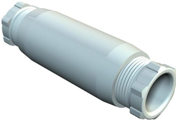
Classe de protection IP54, Tension nominale 660 V. Conformément à la norme VDE, les manchons-raccords sont exclusivement réservés à une pose fixe !
